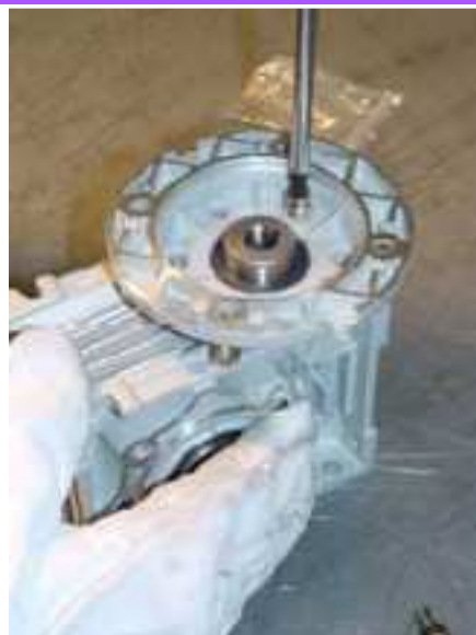
Fot. 4 Przymocowanie kołnierza za pomocą śrub montażowych.
