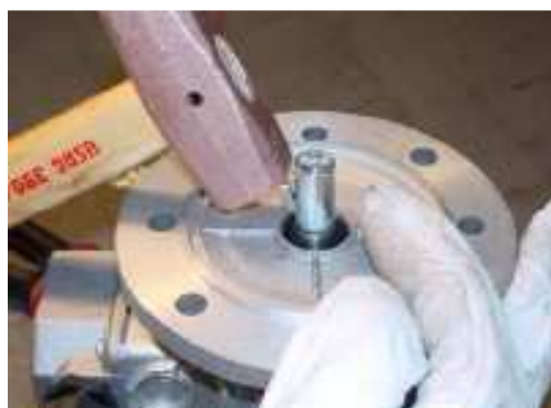
Fot. 6 Nabijanie klina na wałek silnika.
