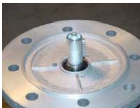
Fot. 7 Widok rękawa założonego na wałek silnika.
